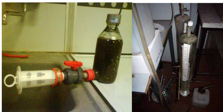
**Figura 1 – Digestore in scala di laboratorio e colonna per la misurazione del biogas. Simulazione del processo anaerobico a partire dalle biomasse campionate in Bissau.**
